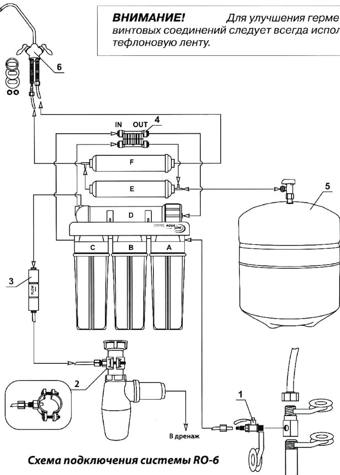
Схема подключения системы RO-6
