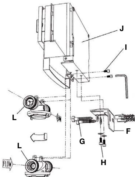
**Внимание:** просим обратить внимание на стрелку на соединительном модуле (**L**). Во время поставки установка имеет конфигурацию для течения по направлению „с лева на право”. Если в месте монтажа течение будет „с права налево” следует повернуть модуль при помощи ключа с шестиугольным гнездом (входит в поставку) следующим образом:
