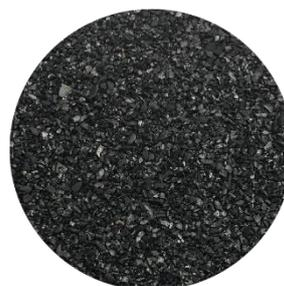
Ecosoft Ecoscarb 8x30 производится из высококачественного каменноугольного сырья. Благодаря высокой механической прочности зерен, в продукте нет мелкодисперсных частиц. Характеристики продукта:
