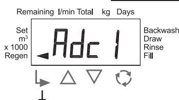
**ШАГ 10D – Измерение тока двигателя в момент перехода**
