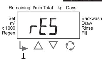
**ШАГ 5Д –** Резервный ресурс. Этот шаг отображается только, если в шаге 3S была выполнена установка фильтроцикла системы. Нажмите «ДАЛЕЕ», для перехода к шагу 6D.
