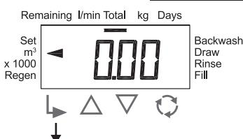
**ШАГ 4Д –** Объем воды очищенной через систему с момента последней регенерации. Нажмите «ДАЛЕЕ», чтобы перейти к шагу 5Д. Нажмите «РЕГЕНЕРАЦИЯ», чтобы вернуться к предыдущему шагу.
