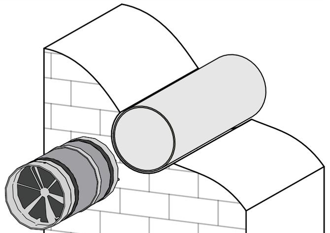
4. С помощью отвертки снимите фронтальную часть блока вентилятора.
