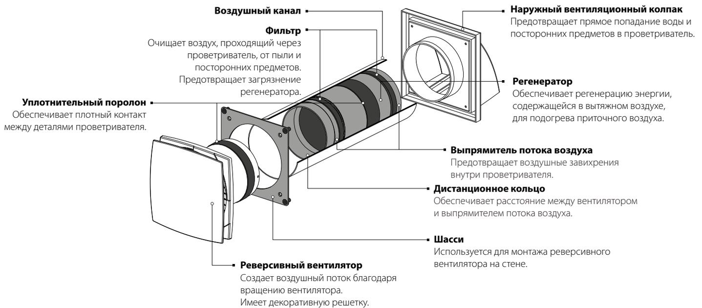
Проветриватель работает в два цикла по 70 секунд.
