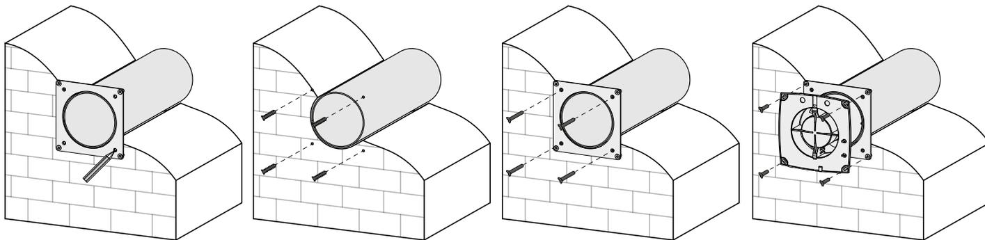
6. Установите фронтальную часть блока вентилятора на прежнее место и закрепите саморезом с помощью отвертки.
