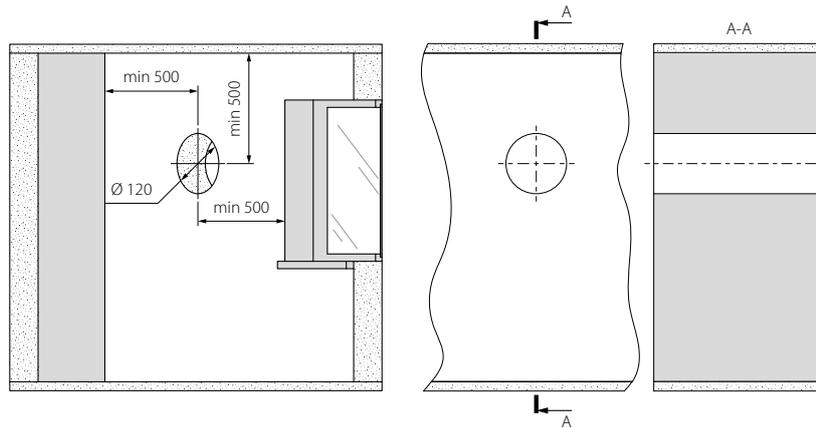
2. Установите воздуховод в стене. Для удобства монтажа используйте пенопластовые клинья, которые входят в комплект поставки. С наружной стороны стены воздуховод должен выступать на расстояние А, необходимое для установки наружного вентиляционного колпака. Расстояние А указано в руководстве к вентиляционному колпаку.
