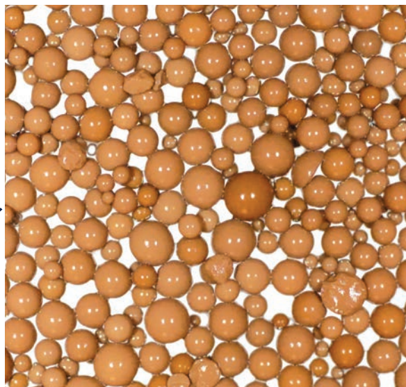
HumiSorb после сорбции органических соединений
